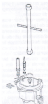
شکل ۵ نحوه صحیح تعویض نازل ها و ابزار مناسب این کار
